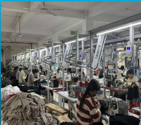
Подвесная конвейерная линия
